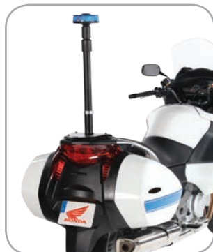
Mât avec gyrophare 360° Contenance des valises latérales : 36,2 l à gauche et 35,1 l à droite
