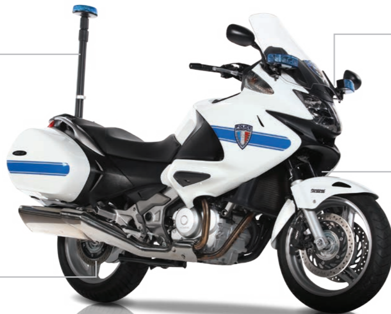
Mât avec gyrophare 360° Contenance des valises latérales : 36,2 l à gauche et 35,1 l à droite
