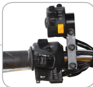
Commodo feux avant et gyrophare arrière
