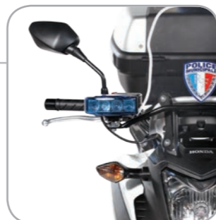
Fixation spécifique des feux avant à LED Tableau de bord
