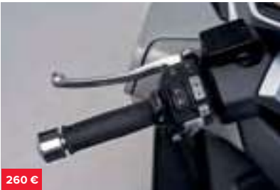
KIT POIGNÉES CHAUFFANTES 08ESY-K40-HG19 Poignées extrêmement minces actives sur toute la surface. Chaleur réglable sur 5 niveaux à partir de la poignée gauche et circuit intégré évitant la décharge de la batterie. Livrées avec le faisceau électrique et le tube de colle à poignées.
